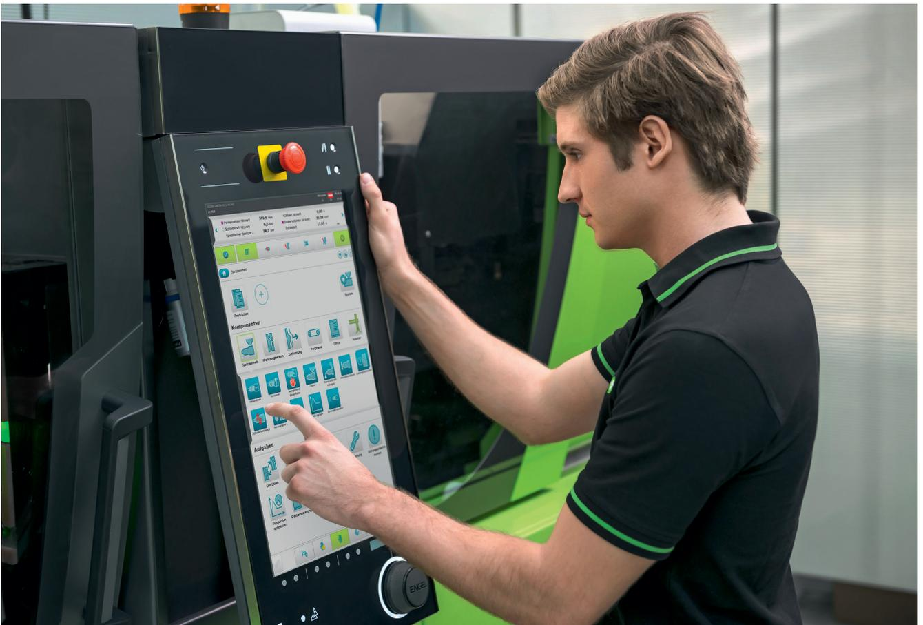
Die Steuerung CC300 ist die Schnittstelle zwischen der Spritzgießmaschine und dem Anlagenbediener. Fühlt sich der Bediener in der Steuerungsumgebung wohl, kann er das Optimum aus der Maschine herausholen (© Engel)
